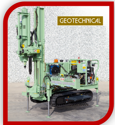
Foto 2 – Máquina de sondagem dinâmica mecanizada (SPT) - Versal Engenharia.
