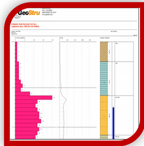
Imagem 3 – Boletim típico do ensaio DP (Prova Dinâmica).
