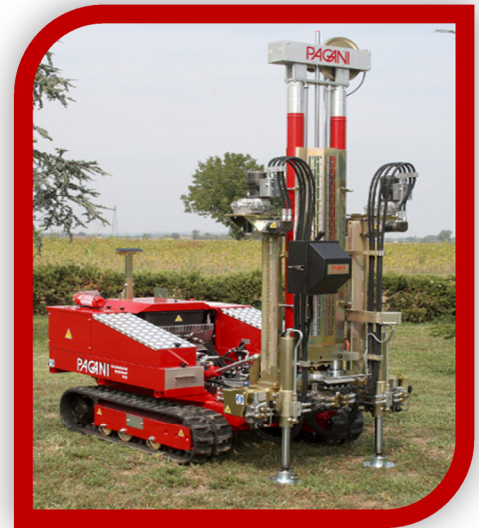
Foto 1 – Máquina de sondagem estática (CPT) - Versal Engenharia.
